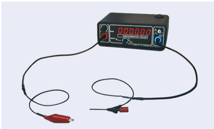
Bild 5 SGZ 21 mit angeschlossenen Generatorkabeln, einer Krokoklemme und einem Mikro-Kleps
