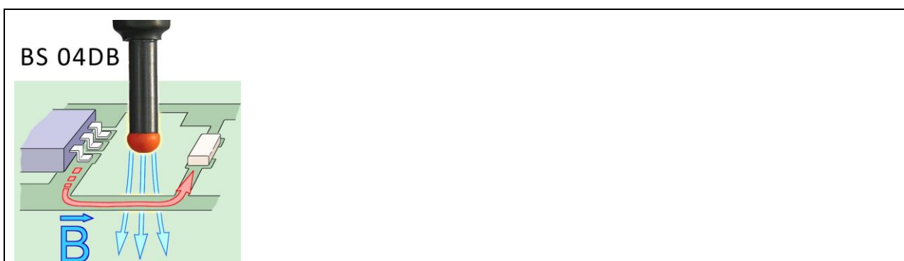
Bild 33 Das Magnetfeld der Feldquelle durchdringt die Leiterschleife und induziert Spannung.
